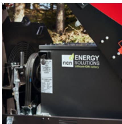
Kraftigt 44 kWh batteri
