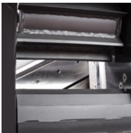
To lange knive med stor åbning på rotor sikrer effektiv hugning.
