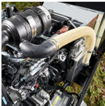
Hatz 4H50 motor med 55 kW
