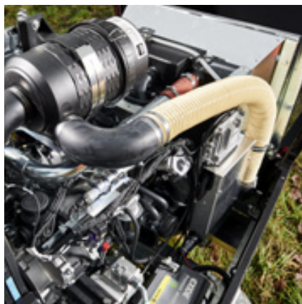
Hatz 4H50 Motor mit 55,0 kW
