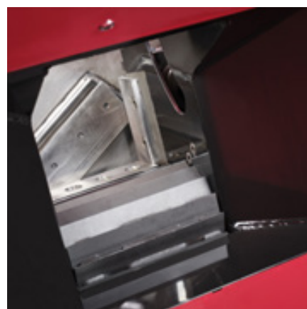
Rodillos horizontales agresivos con apertura de 216 x 265 mm
