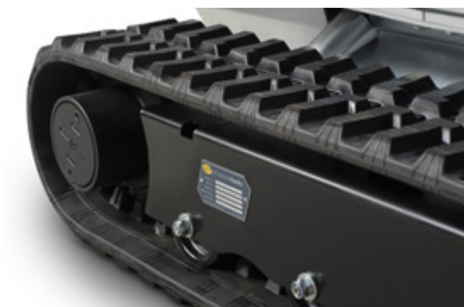
Distancia al suelo de 215 mm. Fácil mantenimiento y sólida protección de las mangueras hidráulicas.
