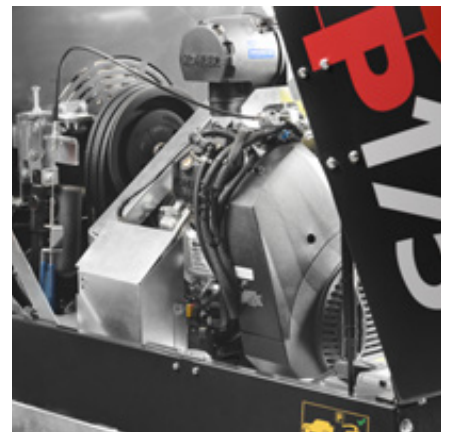
Leistungsstarker Kohler EFI-Motor mit 38 PS
