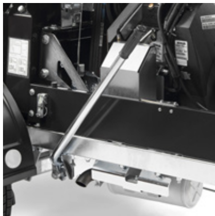
Mechanische Kupplung und Gashebel
