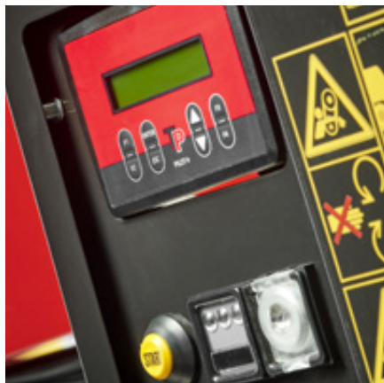
TP PILOT+ mit TP Starter – Automatisches Kupplungssystem zum Ein-/Auskuppeln der Riemen
