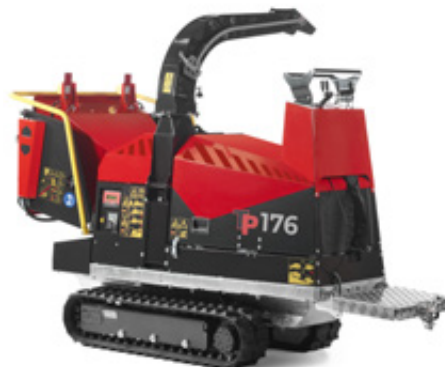
Manuelle Steuerung und Plattform mit Sicherheitsschalter.
