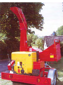
Mobiler Holzhacker mit eigenem Motor
