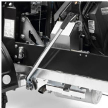
Mechanische Kupplung und Gashebel
