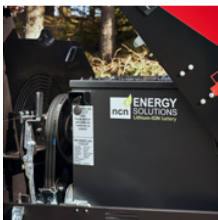
Kraftig 44 kWh batteri
