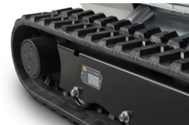
Marknadens högsta markfrigång: 215 mm. Enkel service och gediget skydd av hydraulslangar.
