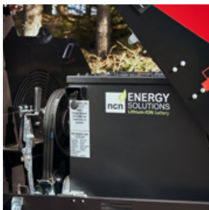
Kraftfullt 44 kWh batteri
