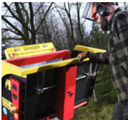
Enkel hantering av den förstärkta kraftiga tratten tack vare gasfjäder
